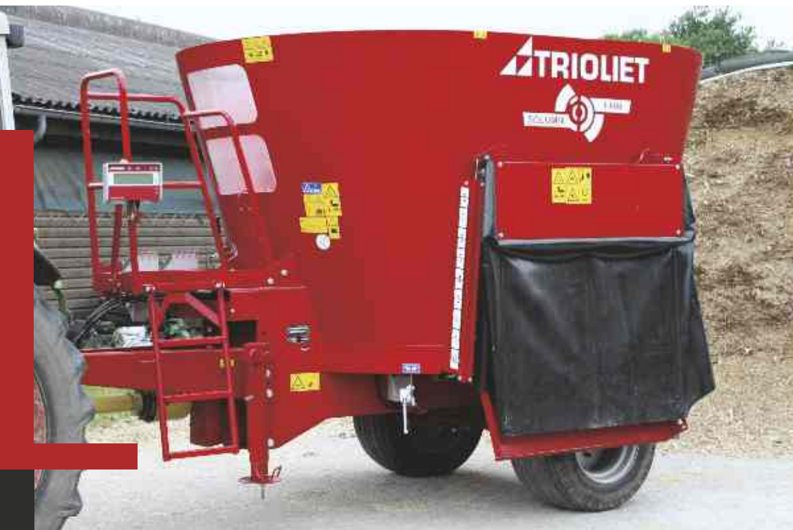
Complete uitdosering door de nieuwe ZK zijkleppen.
