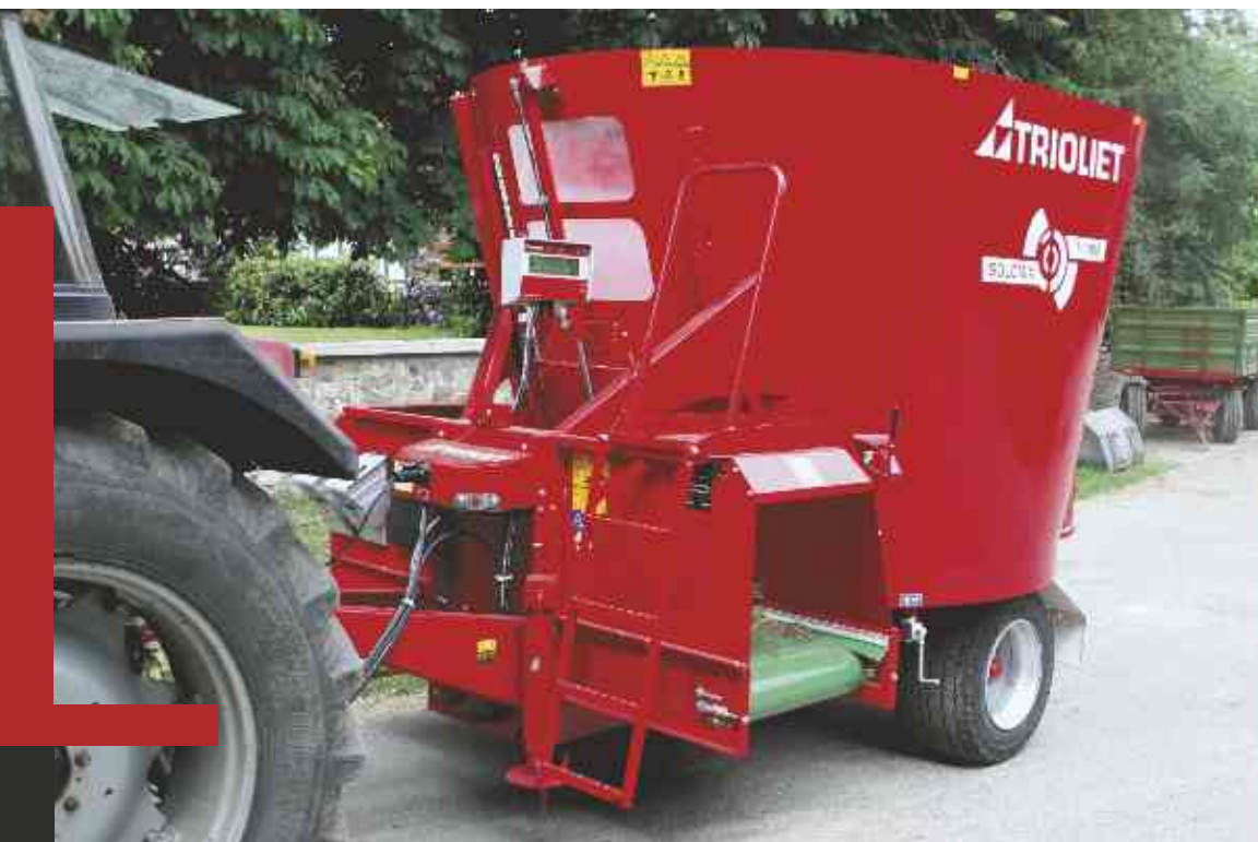
Speciaal voor U-stallen is er de Solomix 1, type ALH-B met dwarsafvoerband aan de achterzijde.
