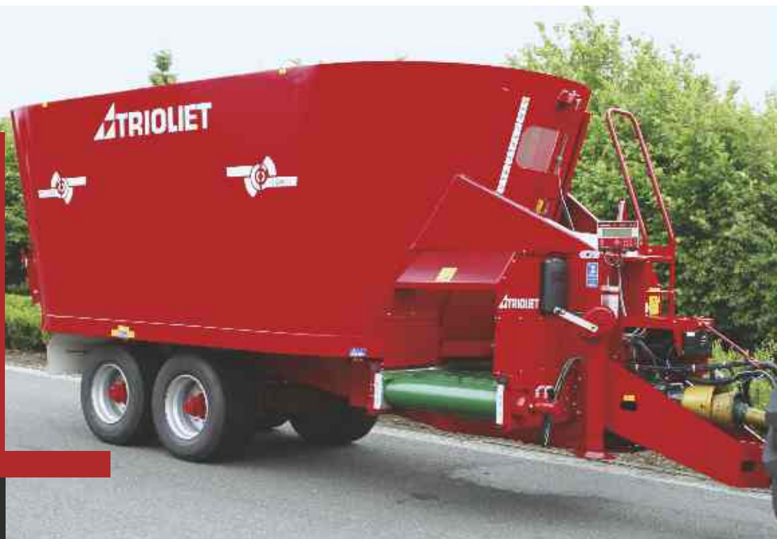
Type VLX-K-T is standaard voorzien van een dwarsafvoerketting aan de voorzijde.
