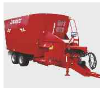
Type VLX-K-T is standaard voorzien van een dwarsafvoerketting aan de voorzijde.
