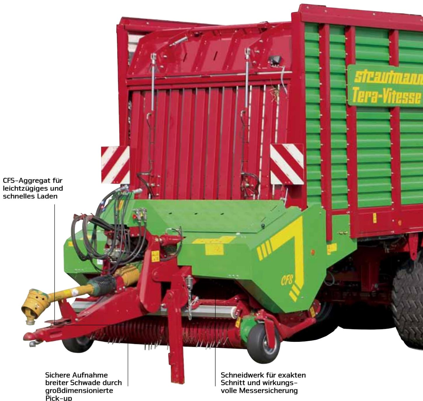
CFS-Aggregat für leichtzügiges und schnelles Laden
