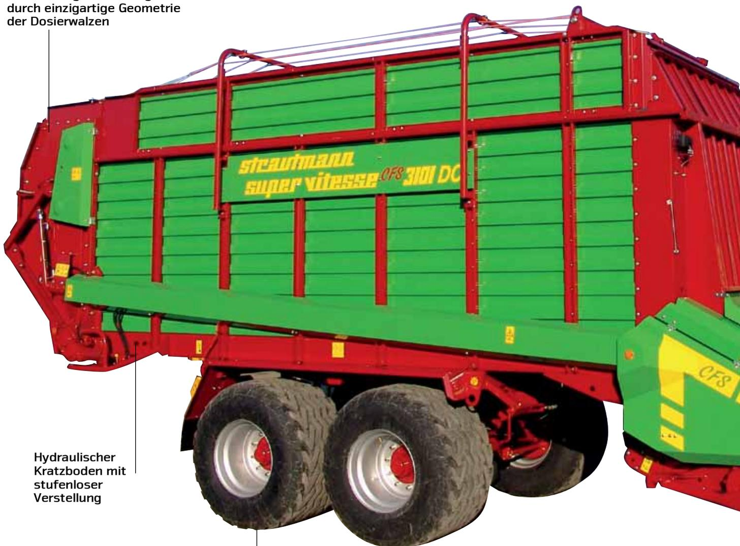
Hydraulischer Kratzboden mit stufenloser Verstellung
