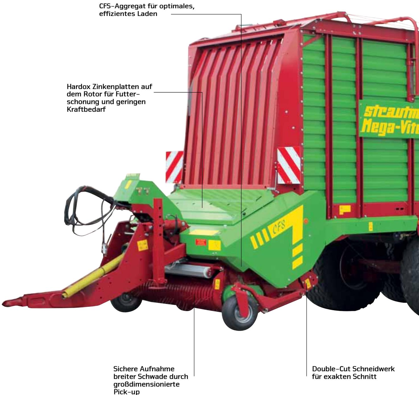
CFS-Aggregat für optimales, effizientes Laden
