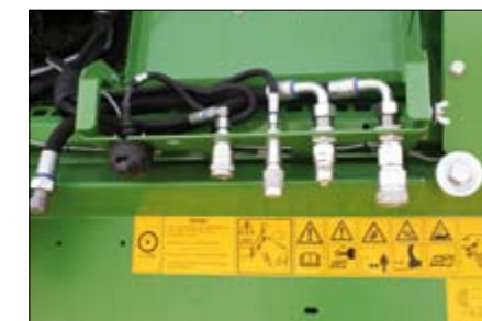
Werkzeuglos Schnellkupplungen der Hydraulikanschlüsse
