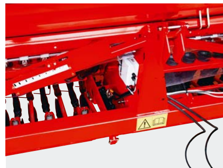
Diepte begrenzing van de zaaiouters, zaaidiepte van respectievelijk 8 cm tot 1 cm.
