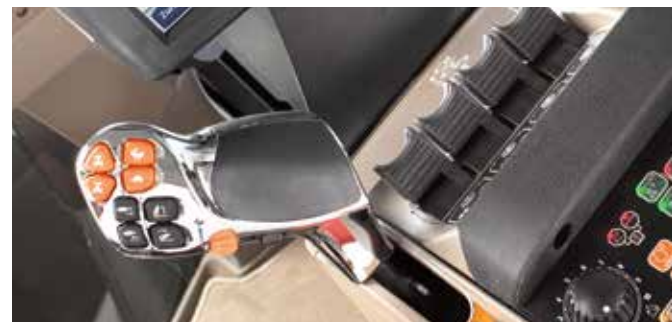
Met de Multicontroller™ kan worden geschakeld zonder gebruik van de koppeling.
