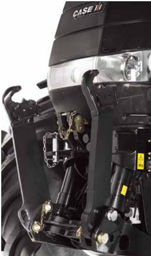
Naadloos geïntegreerde fronthef met een hefvermogen tot 3.785 kg.
