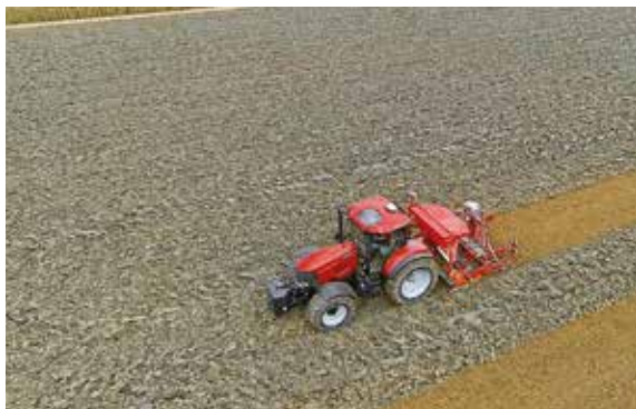
AFS AccuGuide: Geleiding gebaseerd op GPS en GLONASS voor ultieme precisie, ongeacht gewasomstandigheden. Leverbaar met RTK-nauwkeurigheid tot 2,5 cm.
