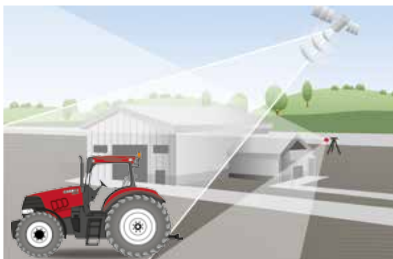
xFill overbrugt RTK-signaalverliezen van maximaal 20 minuten.
