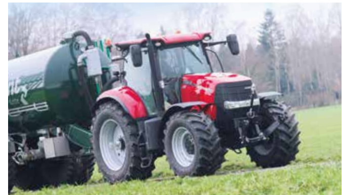
De actieve stopregeling houdt de tractor stil zonder gebruik van de remmen
