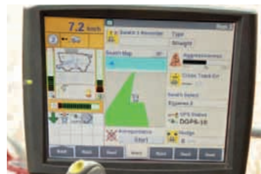
AFS™ Pro 700 touchscreen: controle van opbrengst, brandstofverbruik en werksnelheden, aansluiting van externe camera's en oogstadministratie.
