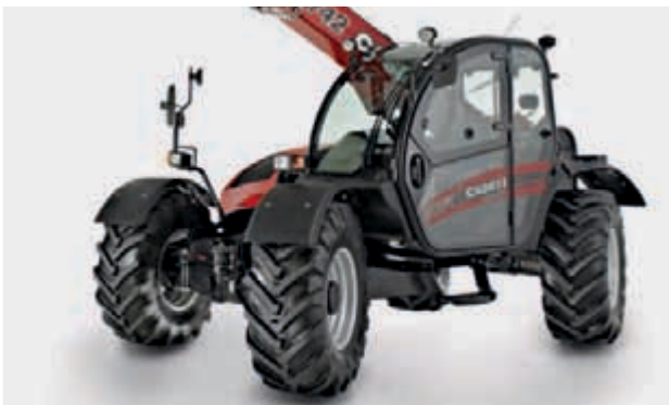
Krabbesturing: zijwaarts bewegen op een rechte lijn, bijvoorbeeld om langs muren te werken.
