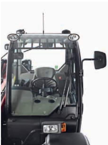
Ladingen zijn steeds zichtbaar dankzij het brede glasoppervlak.
