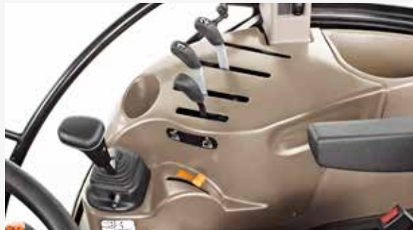
Er zijn tot drie mechanische regelventielen achteraan verkrijgbaar voor de Farmall A-reeks.
